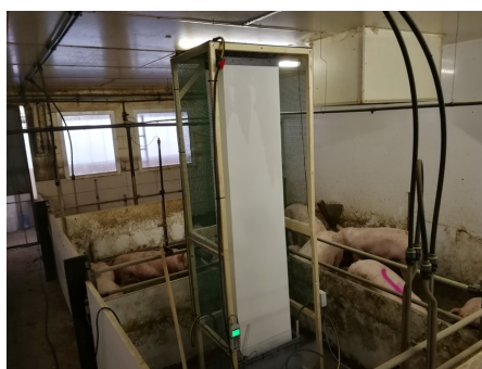
Abbildung 1: Praxisversuch zur kontinuierlichen Adsorption von Ammoniak mit Hilfe von innovativen Adsorbertextilien im Schweinemastbetrieb Schulze Eking, Billerbeck.
