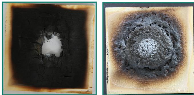
**Abbildung 1:** Ergebnisse eines Fraunhofer WKI eigenen Brandtest an unbehandelten (links, Prüfzeit = 3 Min.) und mit einer intumeszierenden Beschichtung versehende Sperrhölzer (rechts, Prüfzeit = 13 Min.).
